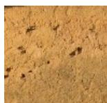
La terre crue, ou **torchis** est un mélange d'argile, de fibres végétales (paille de lin en général), de chaux (liant) et d'eau. Appliqué sur une
